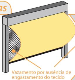
Barras-guia garantem a vedação das bordas laterais por engastamento do tecido em toda a altura. Com isso a fuga de fumaça pelas bordas laterais, sob pressão, é
