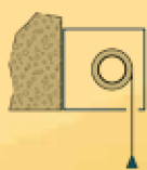
Caixa de enrolamento na parede, frente
