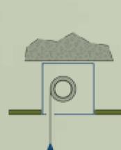
Caixa de enrolamento diretamente no teto, teto rebaixado encosta em ambos os lados na caixa
